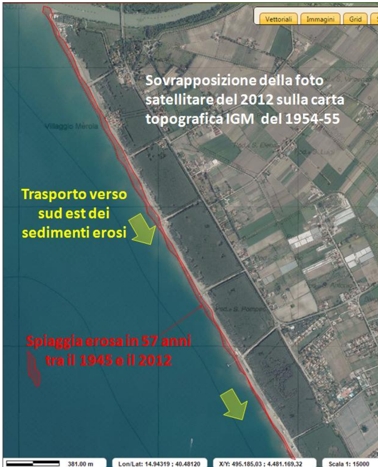
Figura 28: Evidenza dell'erosione della spiaggia avvenuta in 57 anni tra il 1955 ed il 2012. Figura originale elaborata dallo scrivente.
