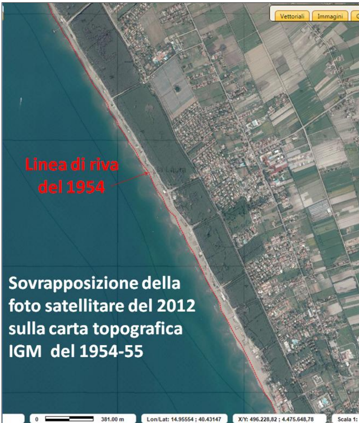
Figura 29: Evidenza dell'erosione della spiaggia avvenuta in 57 anni tra il 19545 ed il 2012. Figura originale elaborata dallo scrivente.
