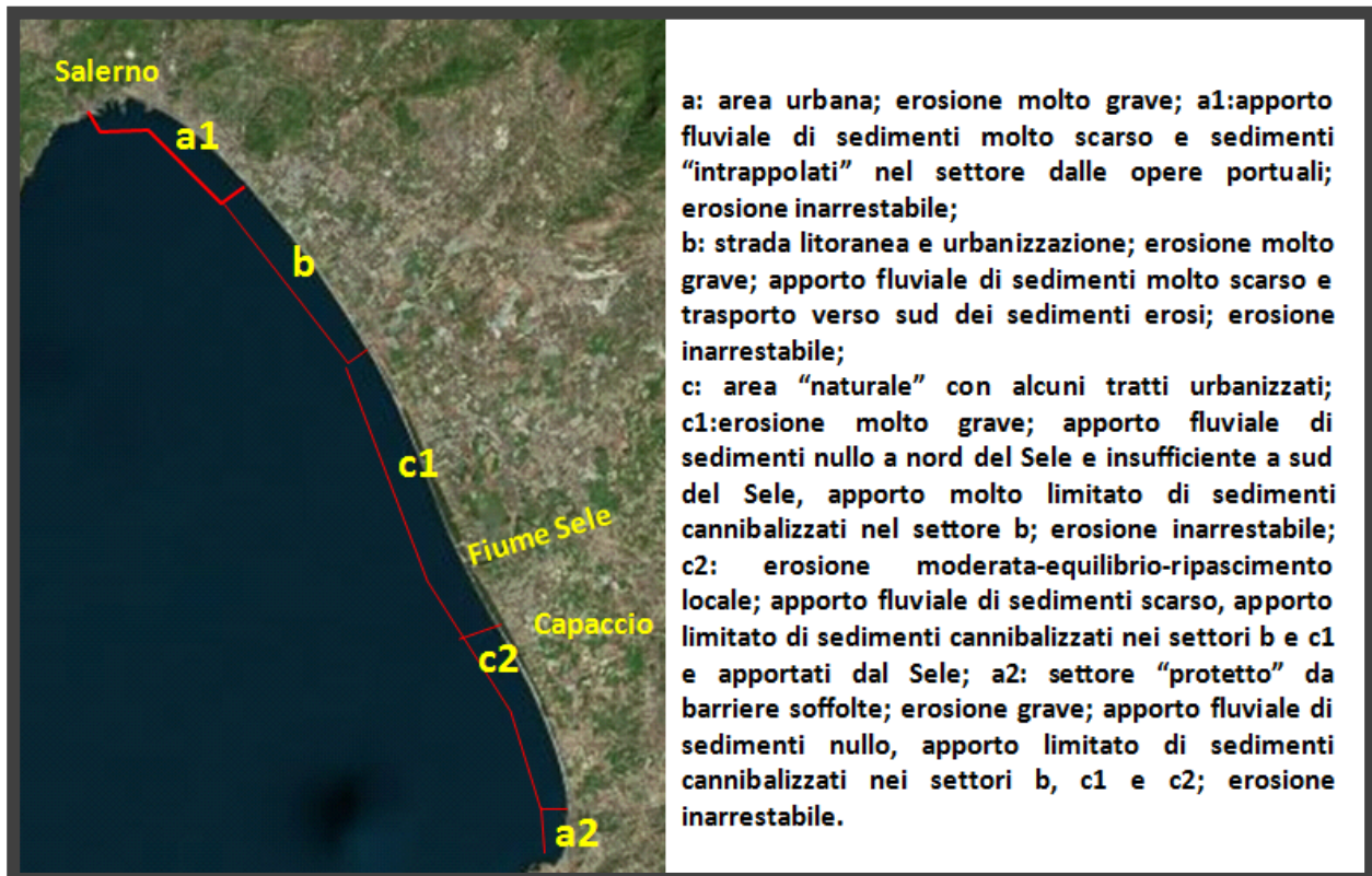
Figura 5: schema della dinamica erosiva e sedimentaria lungo il litorale della Piana del Sele anche in relazione agli interventi antropici già eseguiti lungo la spiaggia in base a rilievi effettuati dallo scrivente durante vari anni di studio lungo il litorale.
