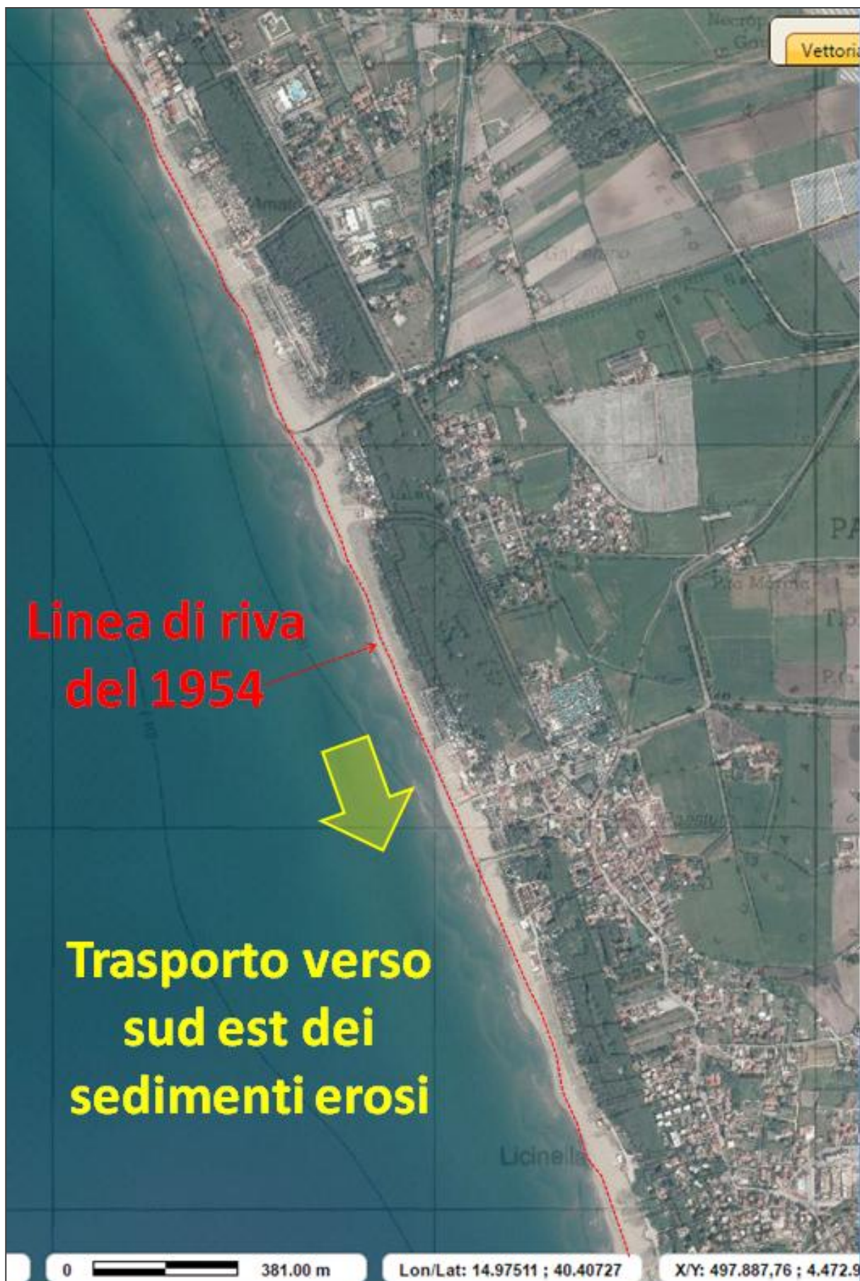
Figura 30: Evidenza dell'erosione della spiaggia avvenuta in 57 anni tra il 1954 e il 2012. Figura originale elaborata dallo scrivente.
