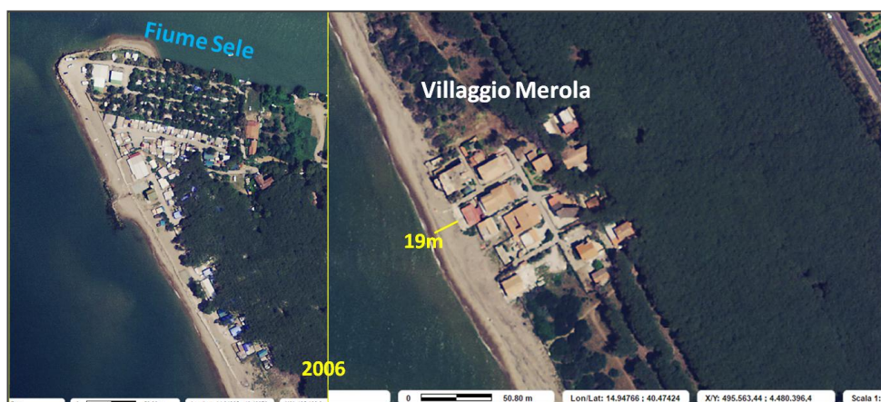
Figura 17: Evidenza dell'erosione della spiaggia in corrispondenza della foce del fiume Sele e del Villaggio Merola nel 2006. Figura originale elaborata dallo scrivente.
