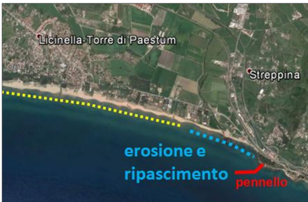
Figura 39: Sintesi della previsione dell'evoluzione della spiaggia (senza pennelli ed altre opere che modifichino il trasporto dei sedimenti lungo costa) nelle prossime decine di anni sulla base dell'evoluzione storica del litorale all'estremità sudorientale della spiaggia di Paestum. Si propone la realizzazione di un pennello sommerso all'inizio della costa alta di Capo San Marco per trattenere i sedimenti che sarebbero dispersi obliquamente rispetto alla spiaggia in maniera irreversibile. Figura originale elaborata dallo scrivente.
