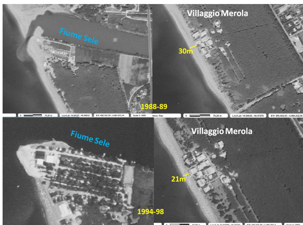
Figura 16: Evidenza dell'erosione della spiaggia in corrispondenza della foce del fiume Sele e del Villaggio Merola tra il 1988 e il 1998. Figura originale elaborata dallo scrivente.
